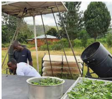
Essiccazione di legumi tramite un essiccatore alimentato ad elettricità solare presso il Centro di Servizio Rurale di Rongerò provincia di Rutana
